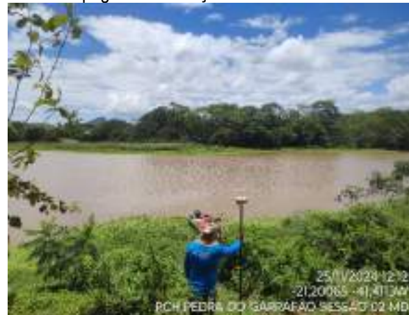
Registro fotográfico 3-10 – Levantamento topográfico da Seção de Controle 02
