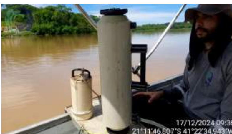
Foto 02 Garrafa de Van Dorn utilizada para coleta de água
