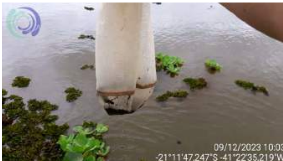
Foto 06 Peneiramento em campo com rede de 500µm
