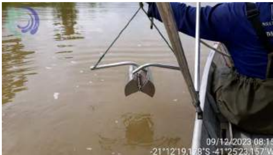
Foto 05 Draga Van Veen utilizada para coleta de sedimento
